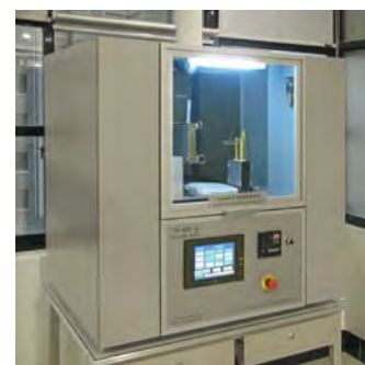
Внизу. Камера для проверки пластика на горючесть.
