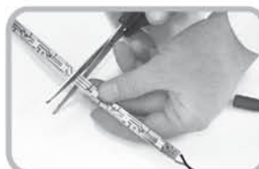
Шаг 1. Разрезать ленту по линии реза.
