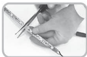
Шаг 1. Разрезать ленту по линии реза.
